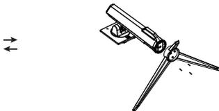
(3) 先将顶部装入槽位，拨动快拆拨片使卡扣收缩回，装好后，松开拨片自动归位锁好。
